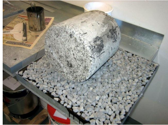
f) Steinefni þrýst ofan í með „valta“ (vantar filt)
