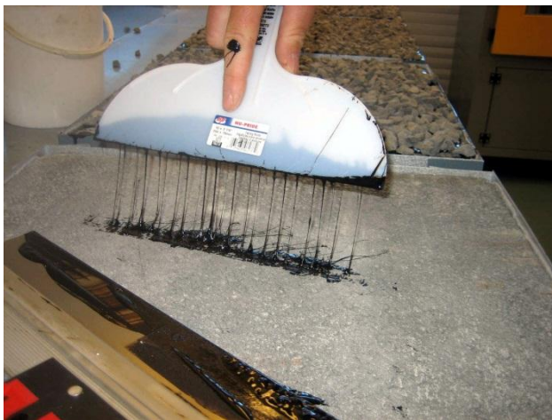
g) Fjölliðubreytt bindiefni togar vel á móti
