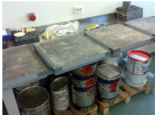
b) Blikkantur límdu á og taulím sett á hornin
